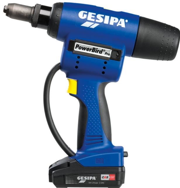
El control de presión garantiza que las piezas a remachar se mantengan unidas sin espacios antes de comenzar el remachado. Garantiza además que el remache alcance su posición final en el orificio antes del remachado y que la cabeza esté en contacto con la aplicación. La fuerza de presión puede ser ajustada según las necesidades requeridas mediante resortes
